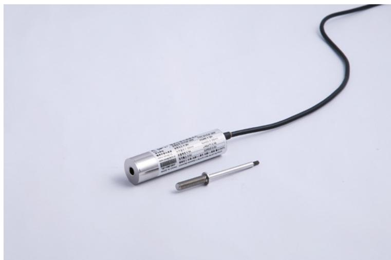
分体式LVDT位移传感器衔铁与传感器主体分离。传感器主体是中空的圆柱体，测量时固定。衔铁与被测物连接，来回运动于传感器主体中，不与主体内壁接触，无任何摩擦，寿命长频响高。
